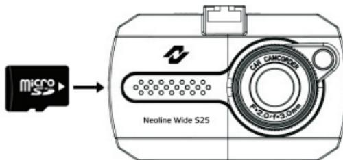
**Предупреждение:** Не прикладывайте чрезмерное усилие при установке карты памяти, во избежание повреждения устройства.
